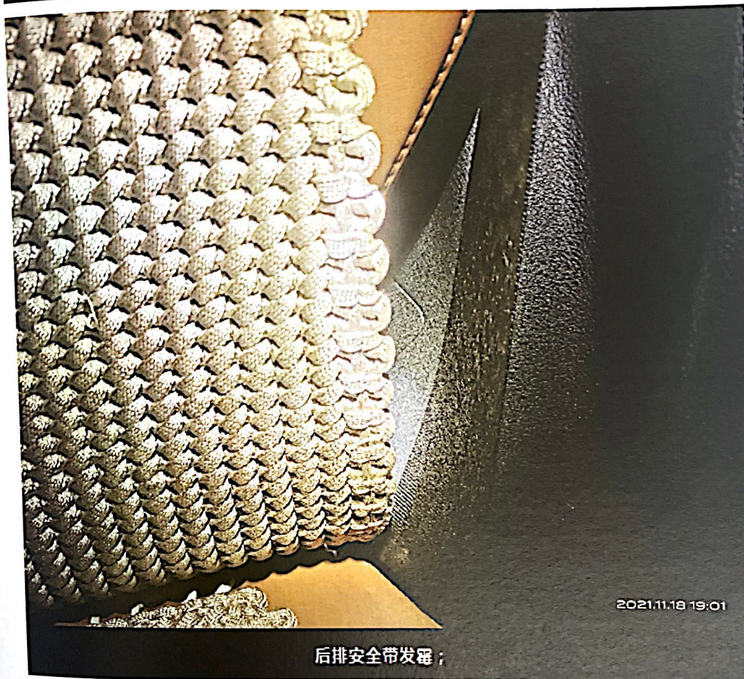
车内地板及死角有水渍, 清洗痕迹, 主驾地板有积水, 边角处有发霉;
