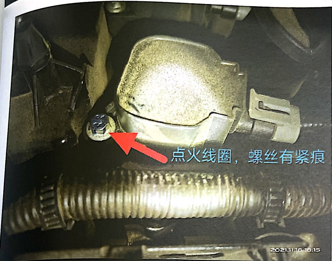
发动机维修历史点火线圈螺丝有紧痕；
